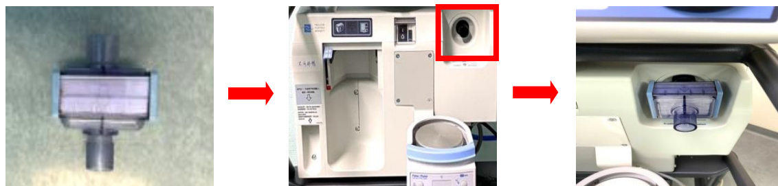
安装吸气过滤器
